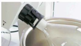
EASY CLIP fermé, Ballon sécurisé
