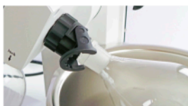
EASY CLIP offen, Kolben ungesichert
